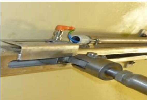
Bild 7 Endlagenschalter "Zu" verbaut an Antrieb (Einstellbereich 150 mm)
